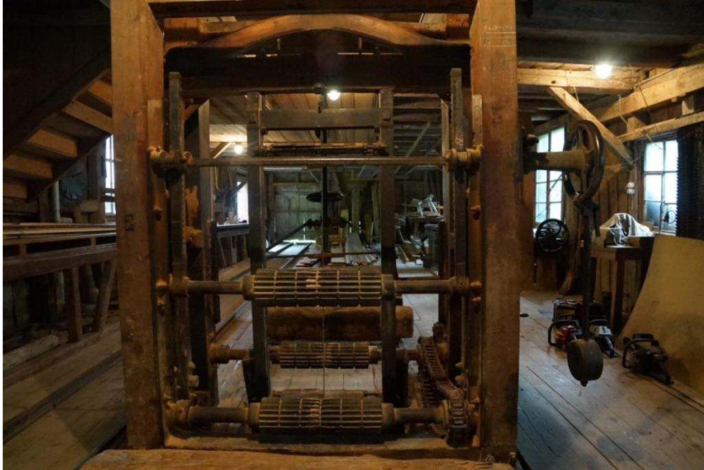
Abb. 148 Säge bei der Liebegg: Das Herzstück der Sägerei, damals und heute, die nach einigen Wartungsarbeiten immer noch funktionstüchtige Gattersäge. Erich Gmünder
