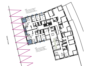
Lärmschutz Grundriss zur Trosser Strasse
