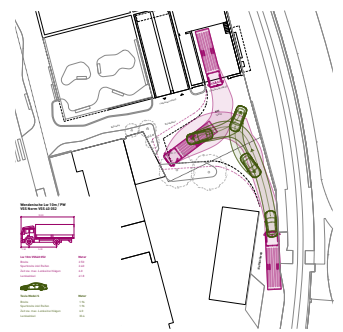
Wendepunkt Hof (Sockelgeschoss)
